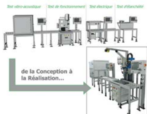
De la conception à la réalisation d'une baie de mesure et de ses différentes unités pour le contrôle en production de pompes à vide.
