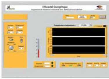
Face-avant de LabVIEW pour afficher la température du salon de HOME I/O et piloter le radiateur.
