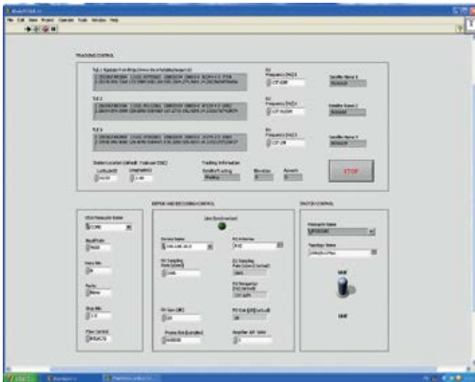
Pupitre de pilotage d'une station de réception pour satellites en orbite basse (chaîne USRP et LabVIEW).
