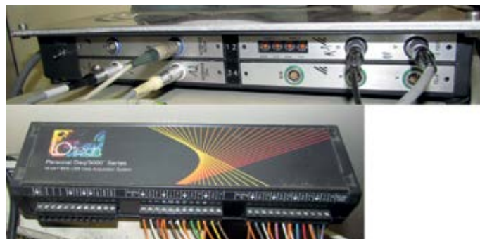
Un PC de bureau dialogue en USB avec le châssis chargé de faire l'acquisition des mesures de pression, couple, position angulaire et coulissement.
