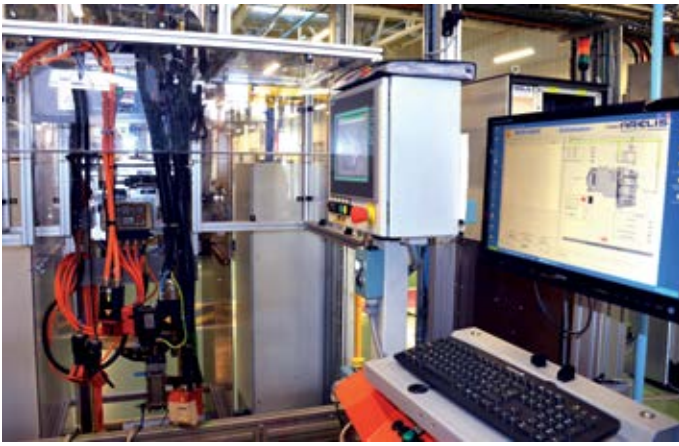
Zone de test PEC intégrant le banc développé.
