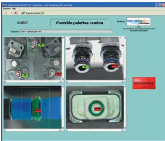
Interface conviviale réalisée sous Vision Builder AI pour un contrôle de ligne de fabrication.
