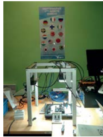
Bâti en profilés pour l'implantation des quatre caméras utilisées pour la formation.
