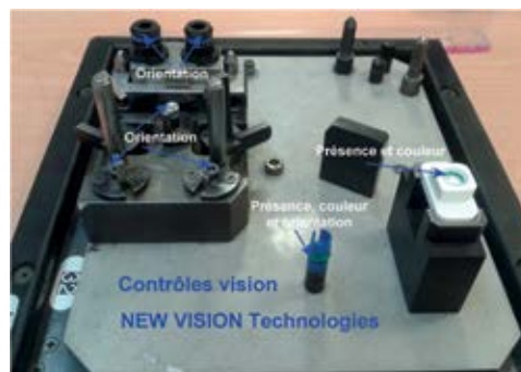
Contrôle automatique de l'implantation des composants par vision industrielle.
