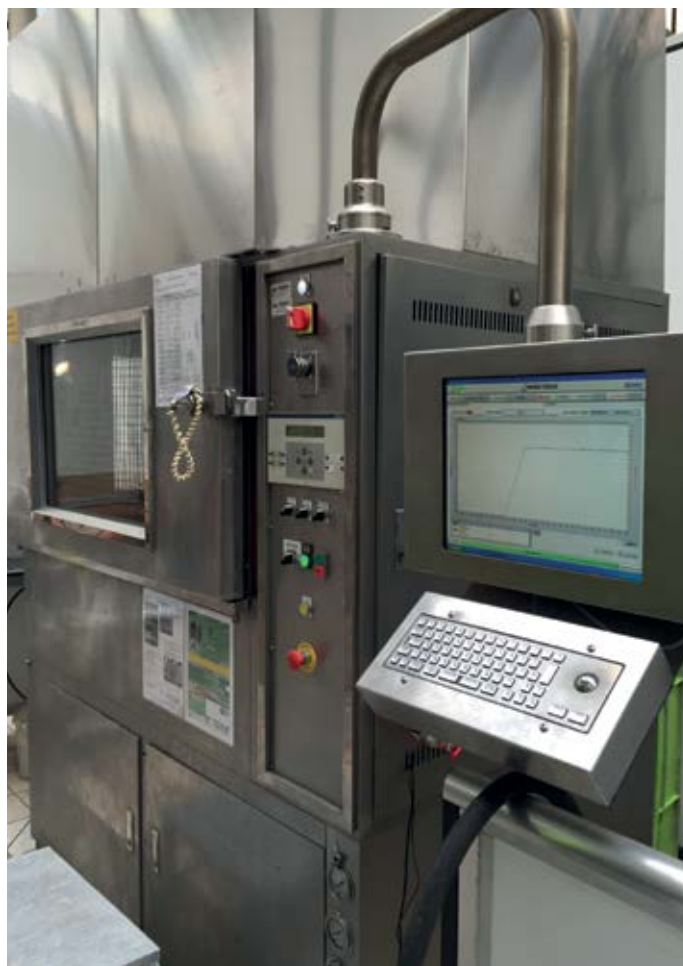
L'objectif est d'intégrer, en parallèle de l'automate existant, une solution NI pérenne et évolutive car l'automate actuel sera amené à disparaître et sera remplacé par une supervision complète du banc sous LabVIEW.
