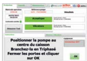
Face-avant de l'interface homme-machine du poste vibro-acoustique.
